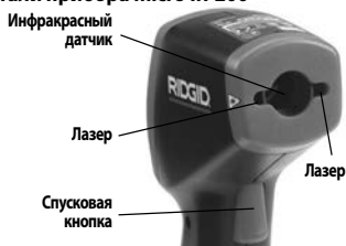
Рис. 2 – Детали прибора micro IR-200
