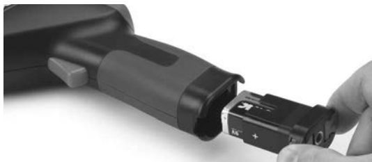
Рис. 5 – Держатель батарейки и маркировка полярности
