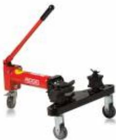
Ручные и электрогидравлические трубогибы предназначены для прецизионной холодной гибки стандартных водогазопроводных труб диаметром от 1/4" до 4". Переносные трубогибы универсального применения идеально подходят для гибки на рабочем месте, а также применяются для механизированных строительных работ, изготовления котлоагрегатов и общего промышленного применения.
