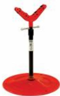
Подставки и опоры для труб различной высоты для осевого вращения и продольной подачи, отличаются разнообразной конфигурацией.
