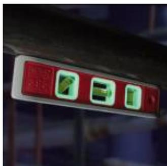
Идеальный уровень для общих работ и работ в труднодоступных местах. Снабжен тремя жидкостными ампулами: горизонтальной, вертикальной и 45°. Изготовлен из алюминиевого профиля с пластиковой вставкой, V-образная канавка для установки на трубы и магнитная полоска для крепления к металлическим поверхностям.
