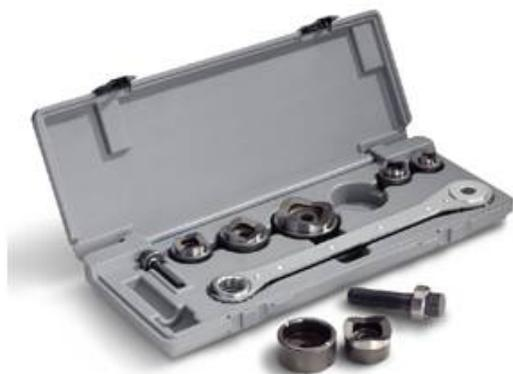
Универсальный инструмент для изготовления отверстий в изделиях из листовой стали, например в электрических шкафах для прокла, металлических контейнерах, ящиках). Применение перфоформ Knockout RIDGID удобно при монтаже электрического щитка для ввода кабеля и установки органов управления, приборов учета; при прокладке инженерных сетей сквозь металлические перегородки, при невозможности использования другого инструмента, например, дрели с биметаллическими коронками.
