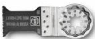
Биметаллическое исполнение с разведенными зубьями для обработки любых древесных материалов, гипсокартона и пластика. Превосходная стойкость, высокое качество реза и оптимальная скорость работы. Исключительная прочность, нечувствительность даже к находящимся в древесине гвоздям (диаметром до 4 мм), кирпичной кладке и т. д. Средняя ширина, зауженная форма для оптимальной скорости резания и эффективного отвода опилок.
