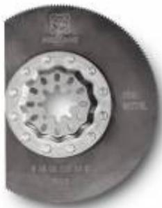
Цельное пильное полотно из быстрорежущей стали с зубьями для резки стальных листов толщиной до 1 мм. Также подходит для пластика, стеклопластика, древесины, замазки (герметика) и цветных металлов. Превосходная скорость резания. Чистый и тонкий рез.
