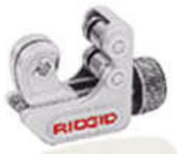
Созданы для резки в тесных местах твердых и мягких медных, алюминиевых, латунных и пластмассовых труб малого диаметра. Прочные, легкие ползун и корпус, большая головка регулирующего винта с накаткой обеспечивают легкую регулировку давления резки для чистоты срезов.
