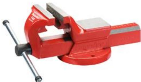
Тиски серии Superior оснащены стационарными трубными губками, расположенными под основными губками тисков, что делает их универсальными. Тиски серии Superior идеальны для работы как с прямоугольными изделиями, так и с трубами. В линейке тисков серии Superior ширина губок от 120мм до 160мм.
