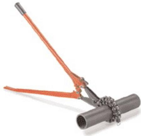
Модель 248 оснащена режущими роликами большего диаметра и длинной ручкой. Разработан для резки цементных и асбоцементных труб диаметром до 19"(480мм).
