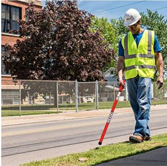
Металлоискатели РИДЖИД (RIDGID) позволяют быстро обнаружить под землей металлические (железосодержащие) объекты - крышки люков, задвижки, стальные и чугунные трубы, стальные корпуса, оболочки скважин, кессоны, знаки-ориентиры на местности.
